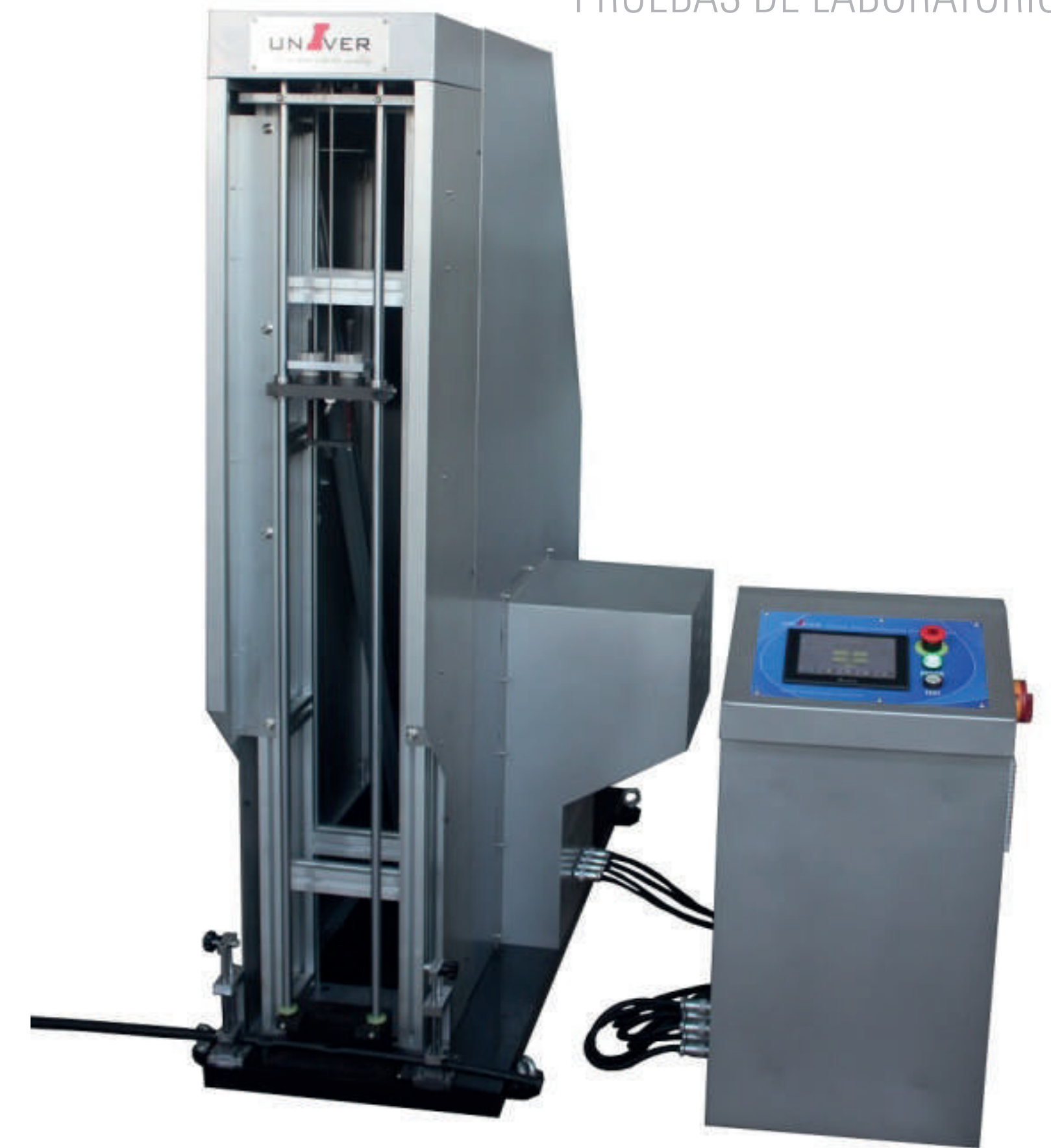
Máquina de impacto, norma internacional “IEC 60794-1-21 optical fiber cables – basic optical cable test procedures. Method E4 – Impact”.
