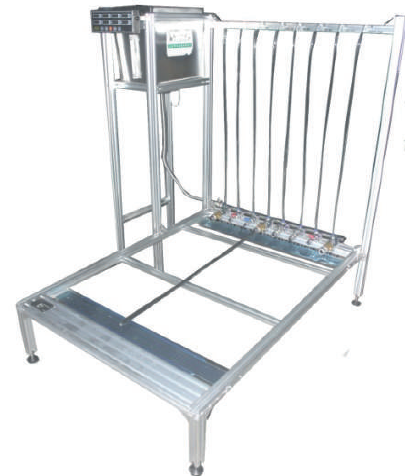
Máquina de penetración de agua, norma internacional "IEC 60794-1-22 optical fiber cables – basic optical cable test procedures. Method FB5 – water penetration".
