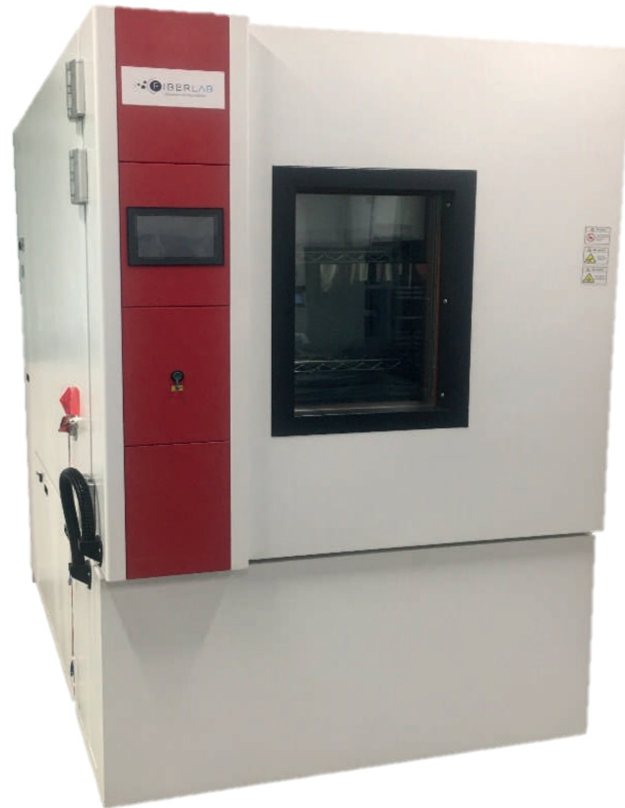
Cámara de envejecimiento térmico, norma internacional "IEC 60794-1-22 optical fiber cables – basic optical cable test procedures. Method F9 – ageing".
