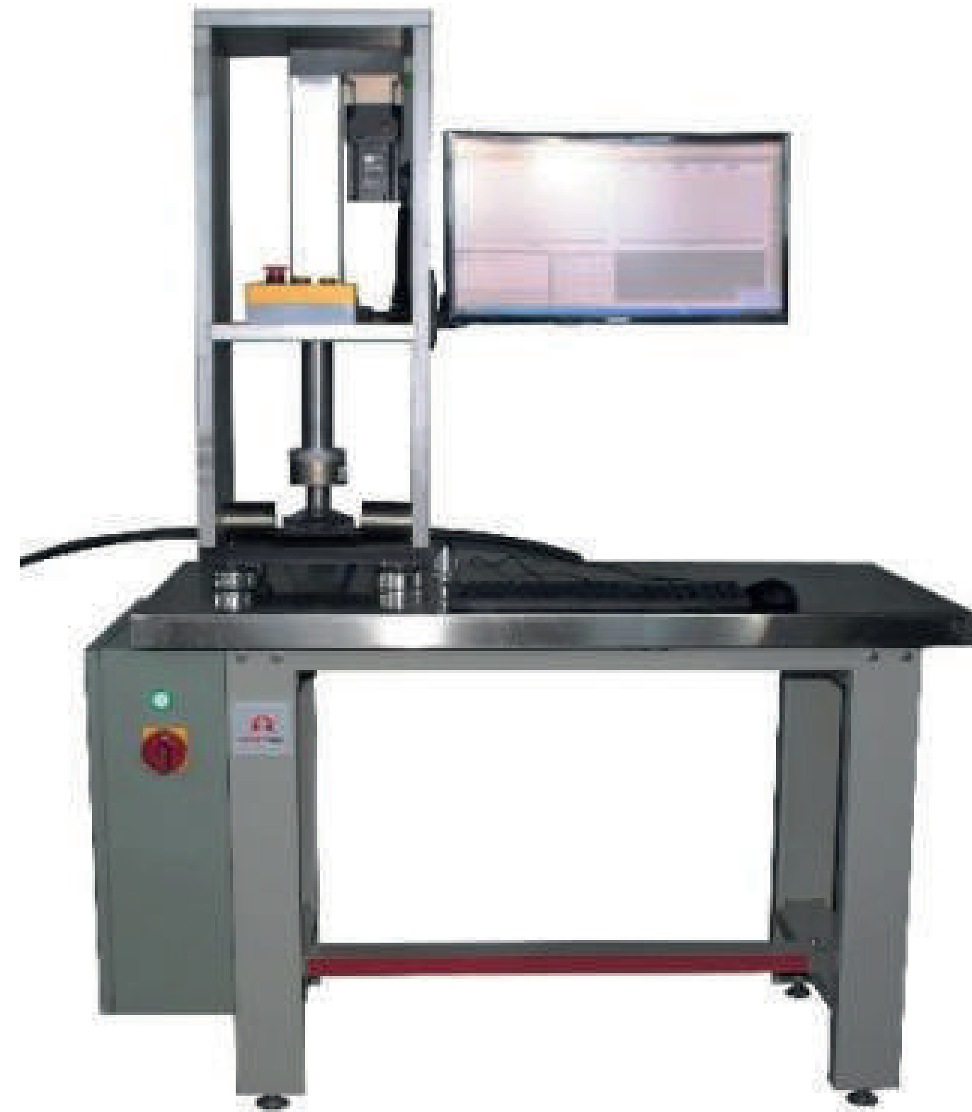
Máquina de compresión, norma internacional "IEC 60794-1-21 optical fiber cables – basic optical cable test procedures. Method E3 – Crush".
