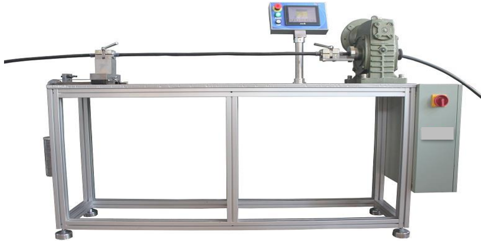
Figura 12. Máquina de torsión, “IEC 60794-1-2 optical fiber cables – basic optical cable test procedures. Method 7 – torsion”. Laboratorio de Pruebas Mecánicas, FIBERLAB S. DE R.L. DE C.V.
