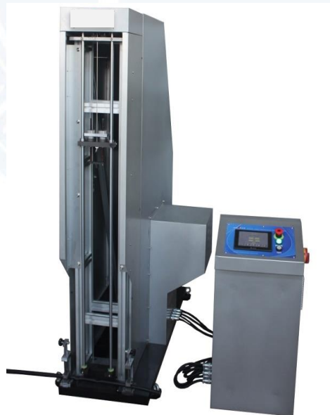
Figura 8. Máquina de impacto, norma internacional “IEC 60794-1-2 optical fiber cables – basic optical cable test procedures. Method E4 – Impact”. Laboratorio de Pruebas Mecánicas. FIBERLAB S. DE R.L. DE C.V.
