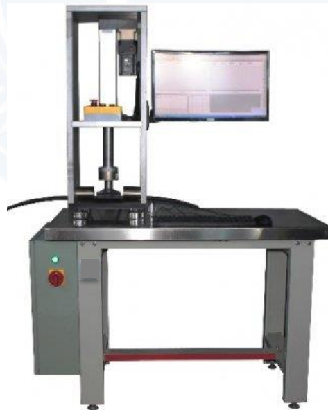
Figura 6. Máquina de compresión, norma internacional “IEC 60794-1-2 optical fiber cables – basic optical cable test procedures. Method E3 – Crush”. Laboratorio de Pruebas Mecánicas, FIBERLAB S. DE R.L. DE C.V.
