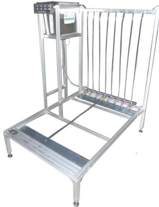
Figura 16. Máquina de penetración de agua, norma internacional "IEC 60794-1-2 optical fiber cables – basic optical cable test procedures. Method FB5 – water penetration". Laboratorio de Pruebas Mecánicas, FIBERLAB S. DE R.L. DE C.V.
