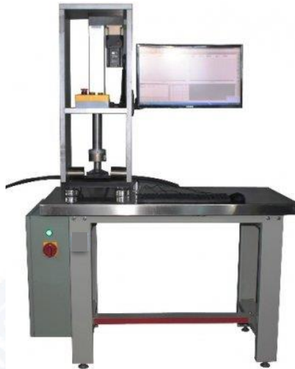
Figura 16. Máquina de corte, norma internacional “IEC 60794-1-2 optical fiber cables – basic optical cable test procedures. Method E12 – Cut-through resistance”. Laboratorio de Pruebas Mecánicas, FIBERLAB S. DE R.L. DE C.V.
