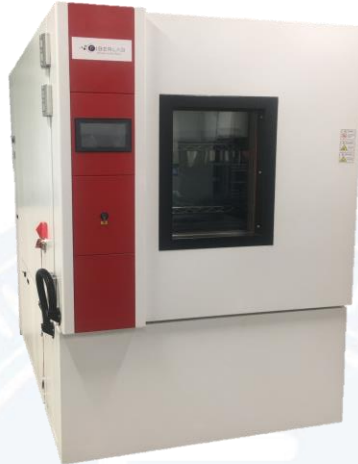
Figura 19. Cámara de envejecimiento térmico, norma internacional “IEC 60794-1-22 optical fiber cables – basic optical cable test procedures. Method F9 – aging”. Laboratorio de Pruebas Ambientales, FIERLAB S. DE R.L. DE C.V.
