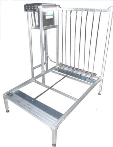
Figura 18. Máquina de penetración de agua, norma internacional “IEC 60794-1-22 optical fiber cables – basic optical cable test procedures. Method FB5 – water penetration”. Laboratorio de Pruebas Ambientales, FIERLAB S. DE R.L. DE C.V.
