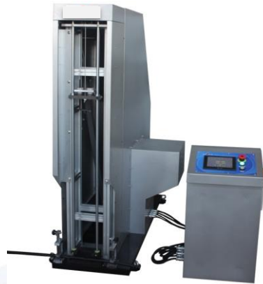
Figura 10. Máquina de impacto, norma internacional “IEC 60794-1-21 optical fiber cables – basic optical cable test procedures. Method E4 – Impact”. Laboratorio de Pruebas Mecánicas. FIBERLAB S. DE R.L. DE C.V.
