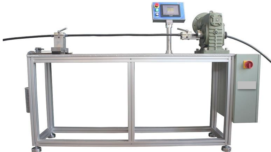
Figura 14. Máquina de torsión, "IEC 60794-1-21 optical fiber cables – basic optical cable test procedures. Method 7 – torsion". Laboratorio de Pruebas Mecánicas, FIBERLAB S. DE R.L. DE C.V.
