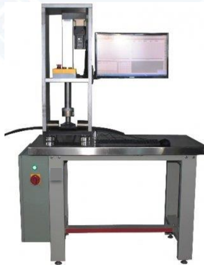
Figura 8. Máquina de compresión, norma internacional “IEC 60794-1-21 optical fiber cables – basic optical cable test procedures. Method E3 – Crush”. Laboratorio de Pruebas Mecánicas, FIBERLAB S. DE R.L. DE C.V.
