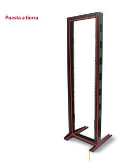
Para la puesta a tierra de cada equipo haga uso del marco de bastidor removiendo un poco de pintura para posteriormente aterrizar en su línea principal.
