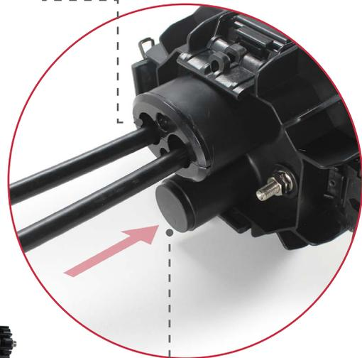
Se acopla en el puerto de cables drop y se utilizan los tubos de plástico, para cubrir el orificio que no se usaría de momento.
