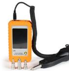
**Microscopio de inspección**
