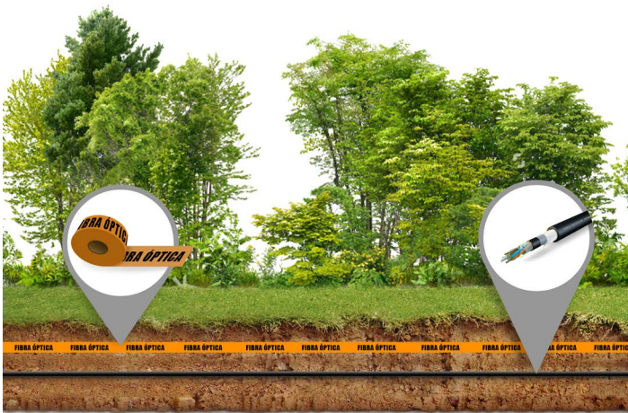
Instalación por enterrado directo
