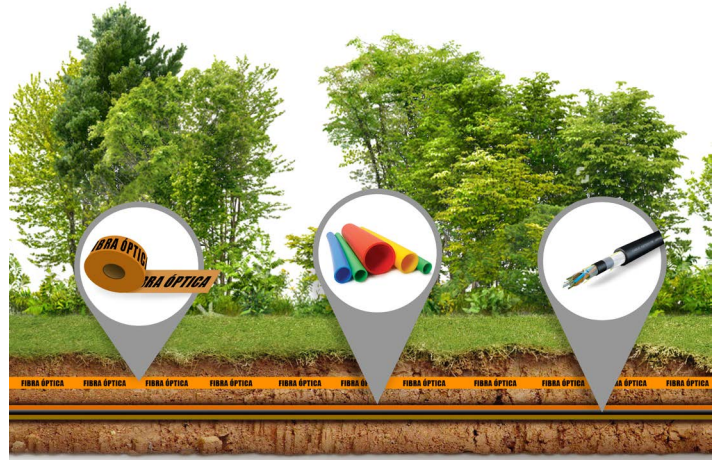
Instalación por ductería enterrada
