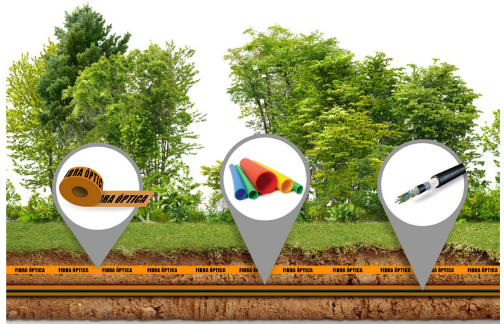
Instalación por ductería enterrada
