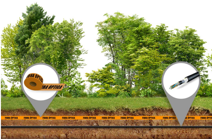
Instalación por enterrado directo
