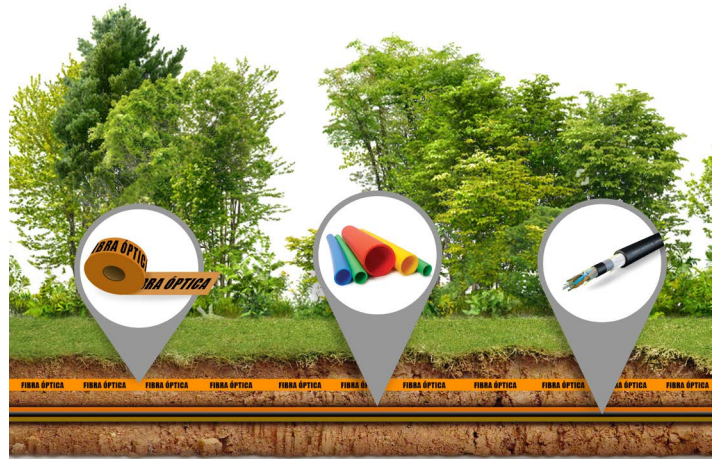
Instalación por ductería enterrada
