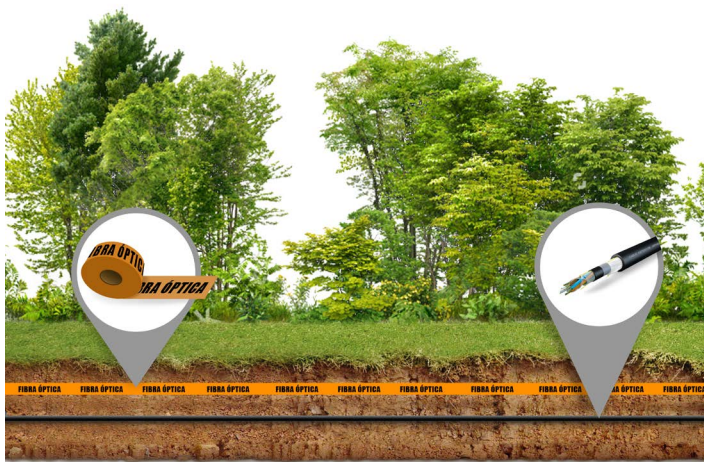
Instalación por enterrado directo
