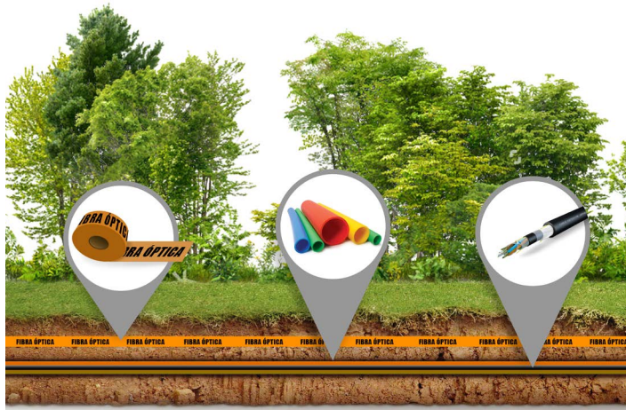
Instalación por ductería enterrada
