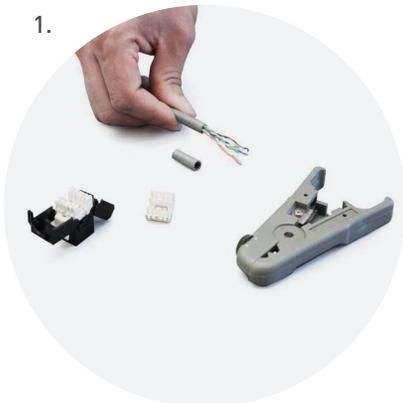
Desforre de cable. Se desforra aproximadamente 3 cm. de la cubierta con el pelador universal.
