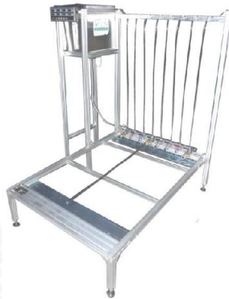
Figura 17. Máquina de penetración de agua, norma internacional “IEC 60794-1-22 optical fiber cables – basic optical cable test procedures. Method FB5 – water penetration”. Laboratorio de Pruebas Ambientales, FIBERLAB S. DE R.L. DE C.V.
