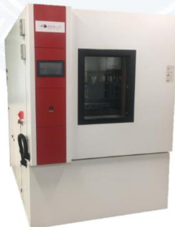
Figura 18. Cámara de envejecimiento térmico, norma internacional “IEC 60794-1-22 optical fiber cables – basic optical cable test procedures. Method F9 – aging”. Laboratorio de Pruebas Ambientales, FIBERLAB S. DE R.L. DE C.V.
