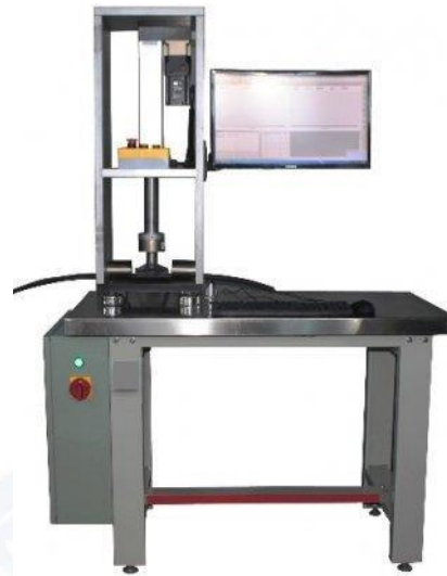
Figura 6. Máquina de compresión, norma internacional “IEC 60794-1-21 optical fiber cables – basic optical cable test procedures. Method E3 – Crush”. Laboratorio de Pruebas Mecánicas, FIBERLAB S. DE R.L. DE C.V.
