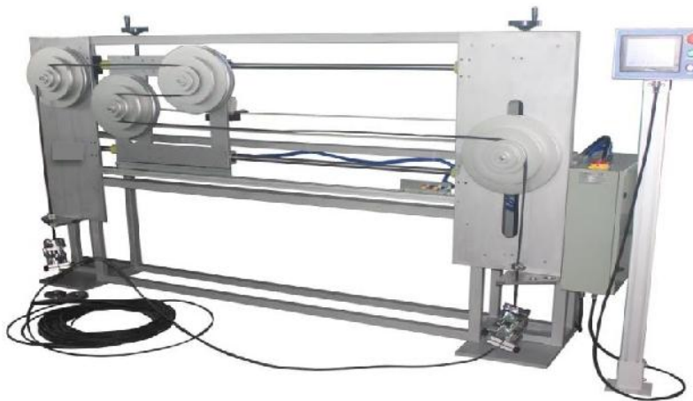
Figura 14. Máquina de flexión, norma internacional "IEC 60794-1-21 optical fiber cables – basic optical cable test procedures. Method 8 – Flexions". Laboratorio de Pruebas Mecánicas, FIBERLAB S. DE R.L. DE C.V
