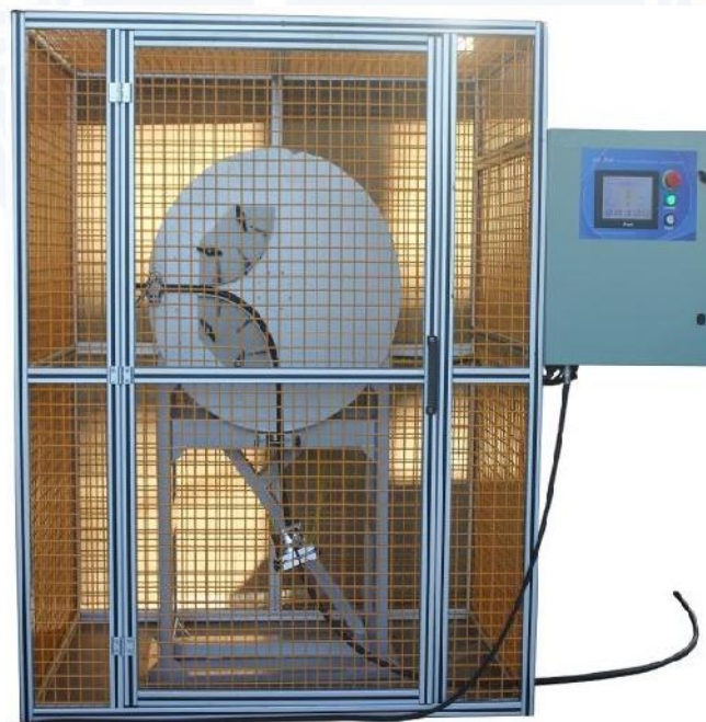
Figura 10. Máquina de dobleces repetidos, "IEC 60794-1-21- Method E6 – repeated bending". Laboratorio de Pruebas Mecánicas. FIBERLAB S. DE R.L. DE C.V.
