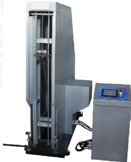
Figura 8. Máquina de impacto, norma internacional "IEC 60794-1-21 optical fiber cables – basic optical cable test procedures. Method E4 – Impact". Laboratorio de Pruebas Mecánicas. FIBERLAB S. DE R.L. DE C.V.
