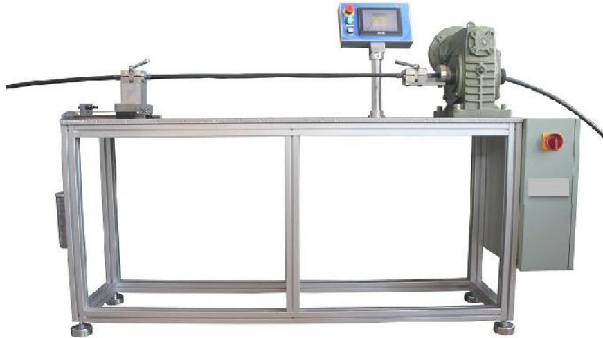
Figura 12. Máquina de torsión, “IEC 60794-1-21 optical fiber cables – basic optical cable test procedures. Method 7 – torsion”. Laboratorio de Pruebas Mecánicas, FIBERLAB S. DE R.L. DE C.V.
