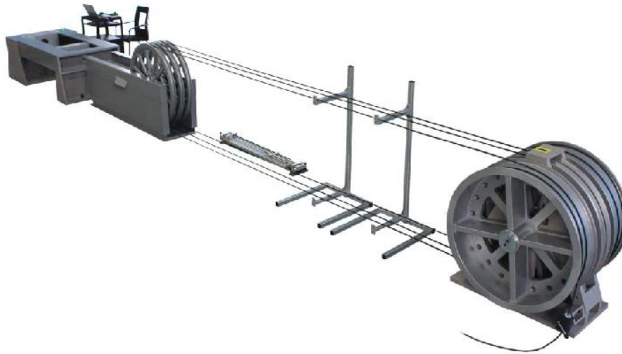
Figura 2. Máquina de tensión, norma internacional " IEC 60794-1-21 Optical fibre cables – Generic specifications -basic optical cable test procedures ". Method E1 – tensile performance". Laboratorio de Pruebas Mecánicas. FIBERLAB S. DE R.L. DE C.V.
