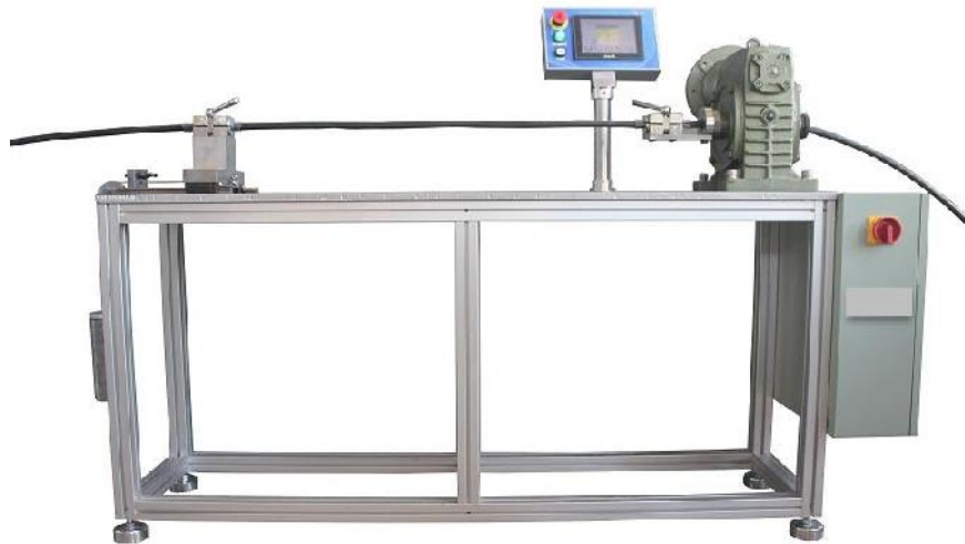
Figura 12. Máquina de torsión, “IEC 60794-1-21 optical fiber cables – basic optical cable test procedures. Method 7 – torsion”. Laboratorio de Pruebas Mecánicas, FIBERLAB S. DE R.L. DE C.V.
