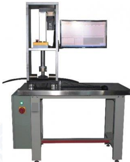
Figura 16. Máquina de corte, norma internacional “IEC 60794-1-2 optical fiber cables – basic optical cable test procedures. Method E12 – Cut-through resistance”. Laboratorio de Pruebas Mecánicas, FIBERLAB S. DE R.L. DE C.V.
