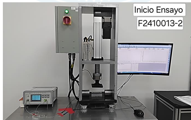
Figura 5. Fotografía del ensayo de compresión. Fuente FIBERLAB.
