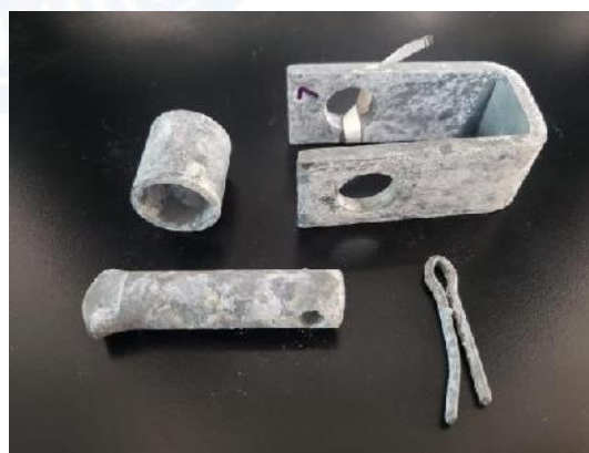
Figura 4b. Herraje D fleje individual 3/16" - OPHAHEDAC1FCH después de 672 h de exposición a la niebla salina
