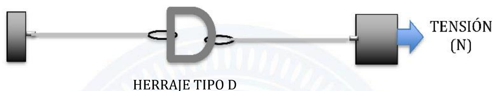
Fig. 5. Diagrama esquemático de la prueba de tensión al herraje tipo D
