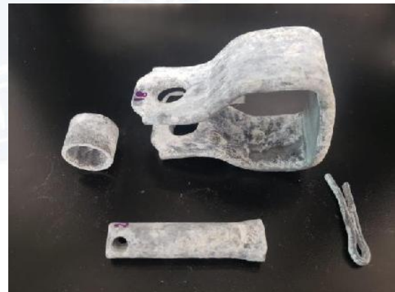
Figura 4b. Herraje doble fleje 3/16" - OPHAHEDAC2FGR después de 750 h de exposición a la niebla salina
