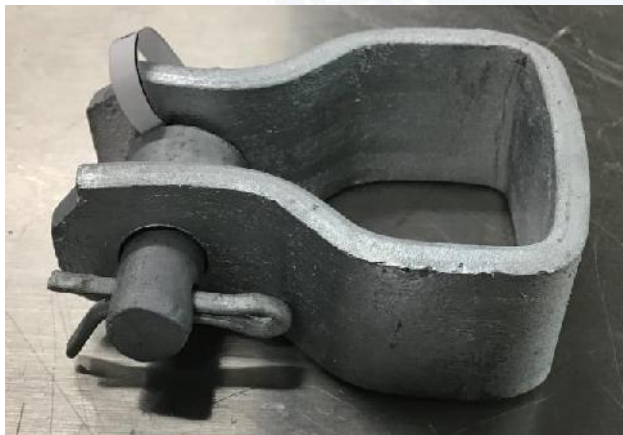
Figura 4a. Herraje D doble fleje 3/16" - OPHAHEDAC2FGR antes de su exposición a la niebla salina
